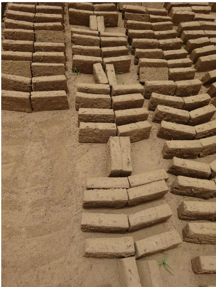
**Figure 5. Briques en cours de séchage posées sur la tranche**
